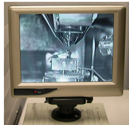
Figura 2. El sistema de HIF además de contar con un microscopio iónico de barrido, posee una pantalla accesoria para visualizar y posicionar las muestras.
